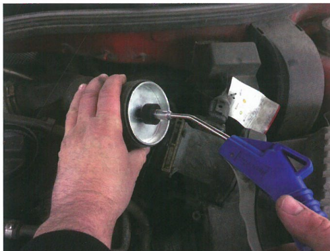
➍ Zkouška těsnosti plnicího a sacího potrubí. ↑
